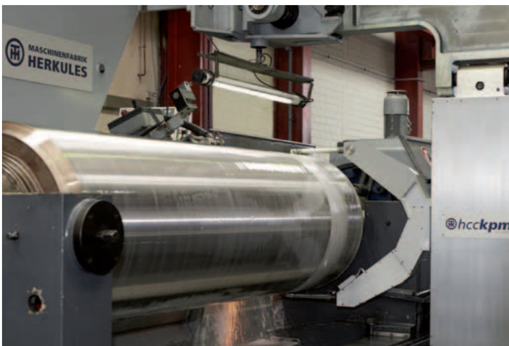
Durch zwei Messsensoren ermöglicht das HCC/KPM System die zeitgleiche Messung und Umsetzung von Events während des Schleifens
