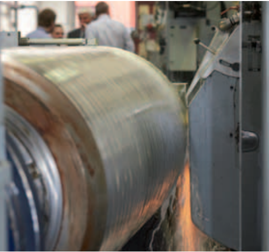
Schleifscheibenschutzhaube speziell für das CBN-Schleifen
