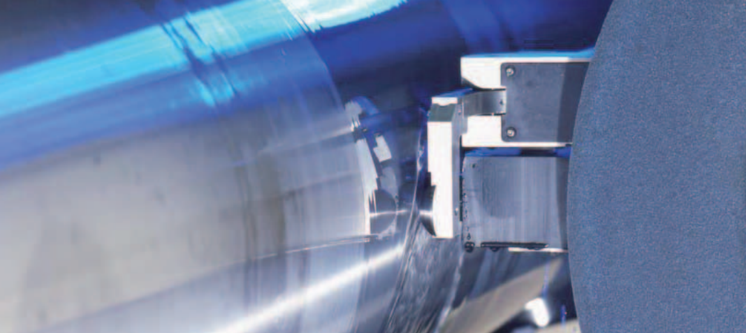
Sichere Lokalisierung von Fehlern in der Walze bevor es zum Defekt kommt: die Herkules Ultraschallanlage
